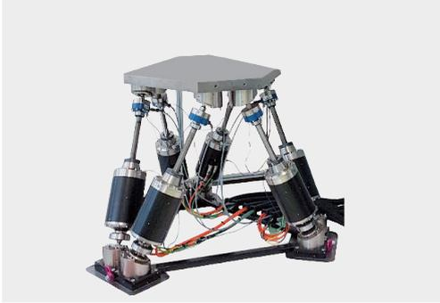
**Robotic-System mit Elektroantrieb**
