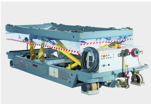
Fahrwerksmontage A380 und A-400M
